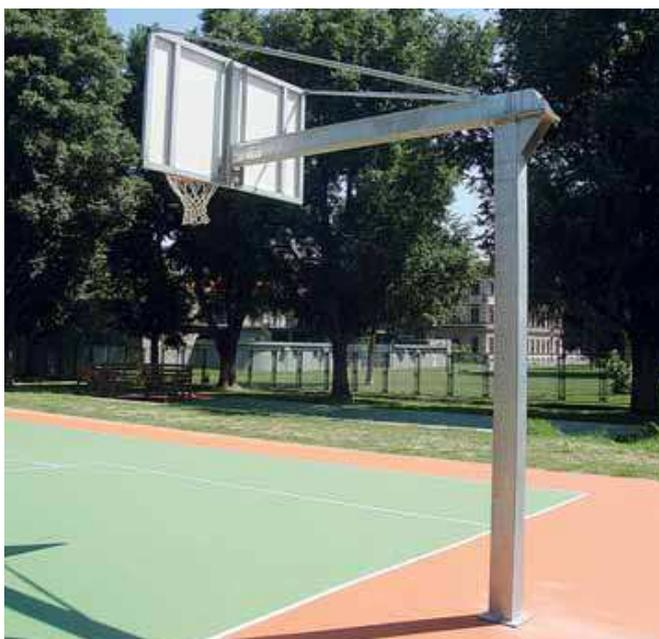
Impianto pallacanestro monotubolare, struttura in tubolare di acciaio zincato mm 150x150, con bossole da interrare, sbalzo cm 160, tabelloni in resina melaminica per esterno spessore mm 10, canestri e retine.
