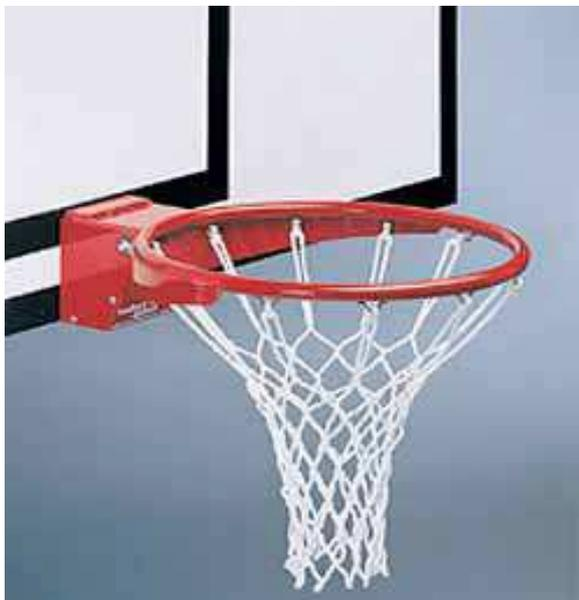
Canestro per basket reclinabile OMOLOGATO Fip, telaio in acciaio verniciato a polvere epossidica, perni in acciaio trattato, molle di richiamo tarate, 4 fori interasse mm 110, 4 fori interasse mm 75
