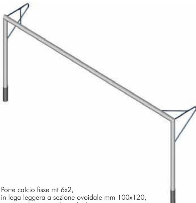
Porte calcio fisse mt 6x2, in lega leggera a sezione ovoidale mm 100x120, traversa divisa, con bossole da interrare, sostegni posteriori reggirete a gomito in acciaio
