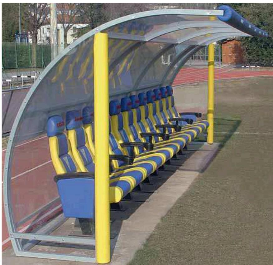
Panchina allenatori calcio curva da m.12 con 24 sedili in plastica struttura in tubo di acciaio zincato a caldo smontabile, pannelli di rivestimento in policarbonato trasparente antiurto, curva molto ampia profondità' cm 180 piani di seduta co scocche mondo seat 6 o a richiesta con supplemento imbottite varie possibilità
