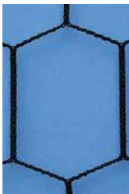
In polipropilene h.t. maglia esagonale mm 100, Ø mm 2,5, peso gr 1400, nastro in poliestere mm 100, cavo in acciaio ricoperto Ø mm 4 (P 030)
