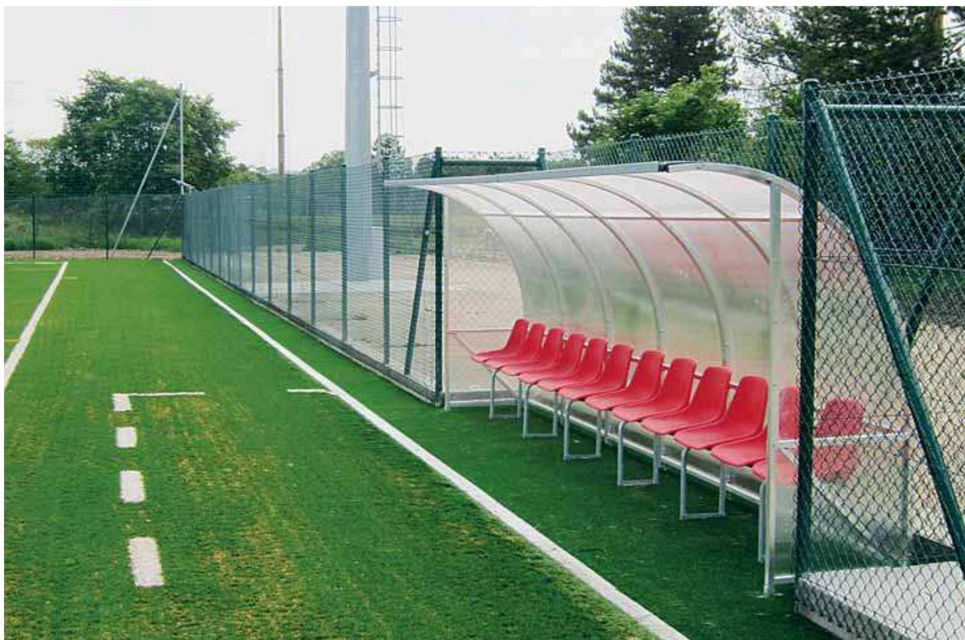
Panchina allenatori calcio curva da m 1 con 2 sedili in plastica colore rosso, struttura in tubo di alluminio finitura naturale sez. mm 30x30, smontabile, composta da moduli lunghezza m 1, pannelli di rivestimento in policarbonato alveolare traslucido spessore mm 6 con protezione anti UV, fianchi in policarbonato trasparente compatto antiurto spessore mm 3 con protezione anti UV. Dimensioni esterne cm 106x75/120x 205 h
