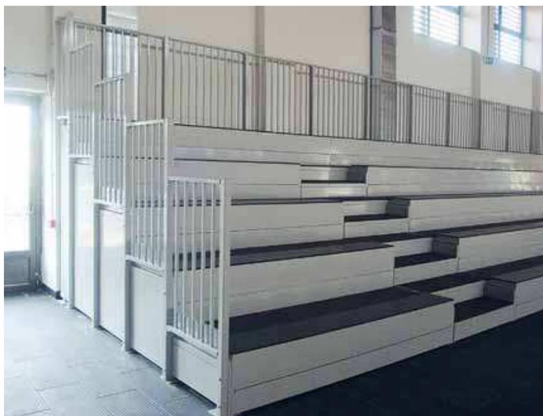
Tribuna modulare da interno veniciata. Composta da lamiera sagomata e struttura metallica di supporto, collegate longitudinalmente tra loro ad incastro su montanti ogni 250 cm. Completa di piani di calpestio, ed elementi di seduta. Dimensioni a richiesta
