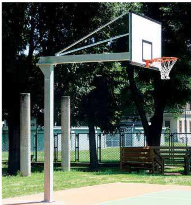
Impianto pallacanestro monotubolare, struttura in tubolare di acciaio zincato mm 150x150 con bossole da interrare, sbalzo regolamentare cm 220, tabelloni in resina melaminica per esterno spessore mm 10, canestri e retine.
